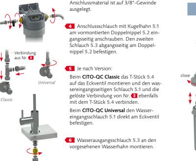
Nach der Installation, Inbetriebnahme und Filterwechsel unbedingt eine Dichtheitskontrolle vornehmen und mindestens einmal nach 30 Minuten wiederholen. Nur mit Kaltwasser betreiben!
