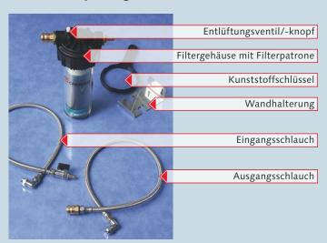
Zum Filterpaket CARBONIT **VARIO** gehören ein Filtergehäuse mit Kunststoffschlüssel, eine Filterpatrone, eine Wandhalterung und zwei vormontierte Edelstahlschläuche: ein Filtergehäuse-Eingangsschlauch mit Schnellkupplungsstecker, Kugelventil, Winkelstück und Dichtung sowie ein Filtergehäuse-Ausgangsschlauch mit Schnellkupplung, Winkelstück und Dichtung.
