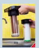
Die neue Filterpatrone wird in die Filtertasse eingelegt. Wichtig: Die mit einer Dichtung versehene und innen gelochte Seite der Filterpatrone muss beim Einlegen nach oben zeigen.
